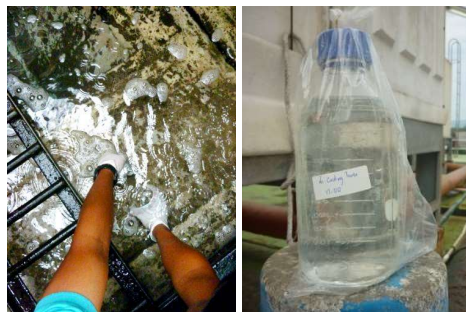
ภาพที่ 10-D การเก็บตัวอย่างเพื่อตรวจวัดการปนเปื้อนของเชื้อ Legionella ในระบบระบายอากาศ
